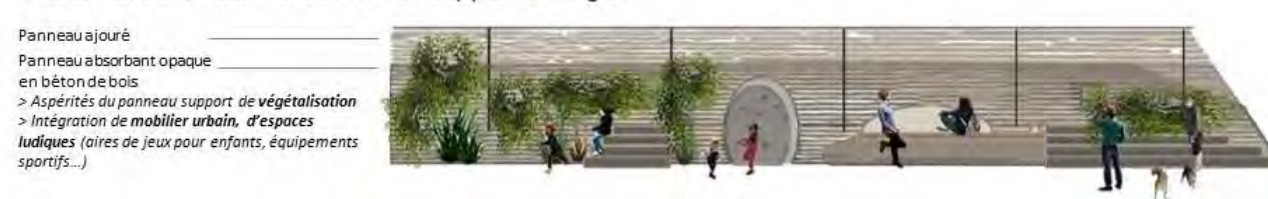
Figure 14 : Traitement architectural des écrans acoustiques (© Ingerop)
